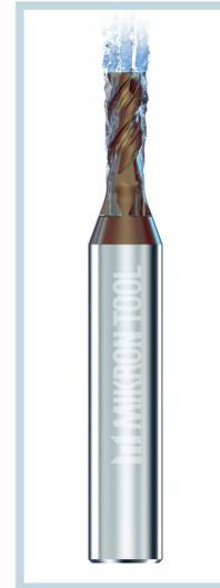
4 Die integrierte Kühlung der Werkzeuge von Mikron Tool trägt maßgeblich zu deren langen Standzeiten, der mit ihnen erreichbaren hohen Abtragraten sowie der erzeugten sehr guten Oberflächenqualität am Bauteil bei
